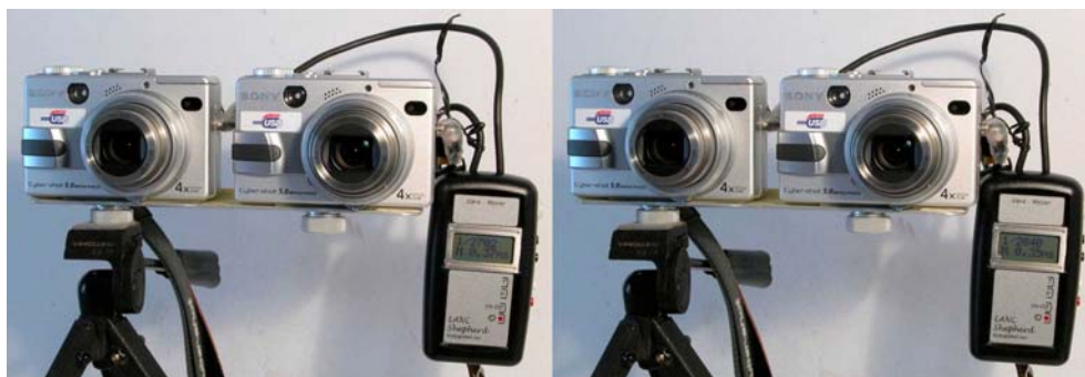
Double Sony DSC-V1 et boîtier de commande Lanc Shepherd
